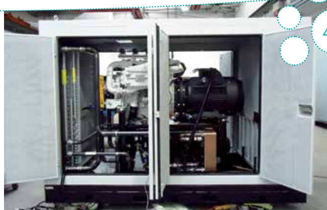
AGREGAT KOGENERACYJNY W OBUĐOWIE DŹWIĘKOCHŁONNEJ O MOCY ELEKTRYCZNEJ 50 KW, PRACUJĄCY NA POTRZEBY AQUAPARKU W KUDOWIE ZDROJU
