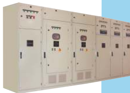
Układ redundantny dwóch soft-startów z szafą przyłączeniową, każdy soft-start może dokonywać rozruchu trzech silników (pompy pożarowe 110 A / 3300 V)
