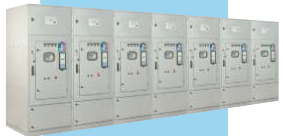
Rozruch czterech silników z jednego soft-startu, podwójny system zasilania, z osobnymi odłącznikami dla każdego silnika (6600 V / 250 A)
