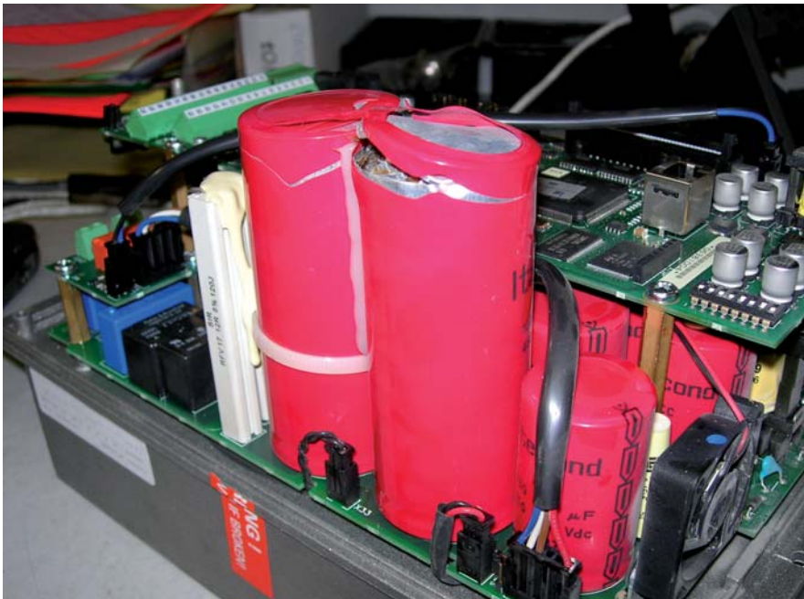
Rys. 1. Skutki starzenia się kondensatorów
